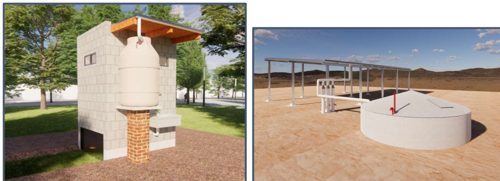
Figura 1. Izquierda: baños secos. Derecha: sistema de recolección y almacenamiento de agua de lluvia.
